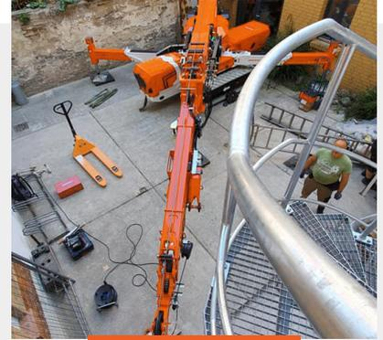
Tiene una elevada capacidad de elevación en relación con su superficie de estabilidad
